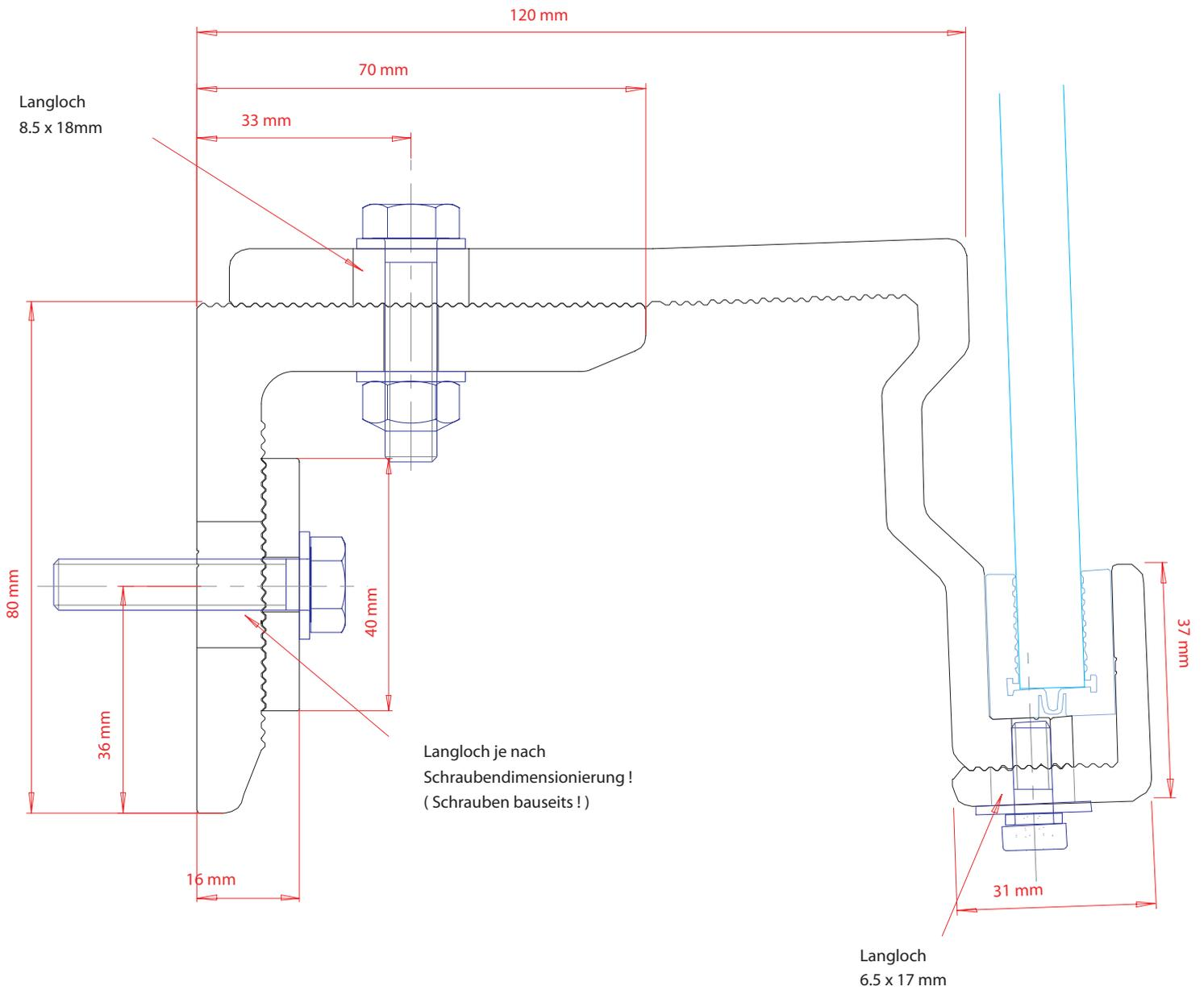
Die Dimensionierung des Glases kann laut den Berechnungstabellen angewendet werden. Glasgrößen die nicht in den Tabellen angeführt sind müssen bauseits durch einen Glasstatiker geprüft werden.
