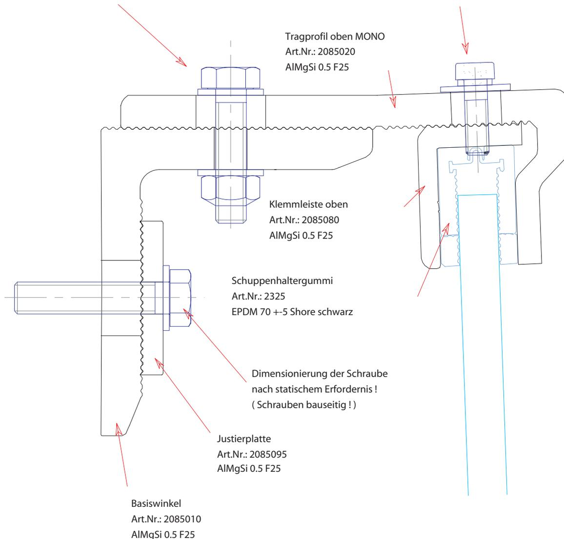
Die Dimensionierung des Glases kann laut den Berechnungstabellen angewendet werden. Glasgrößen die nicht in den Tabellen angeführt sind müssen bauseits durch einen Glasstatiker geprüft werden.
